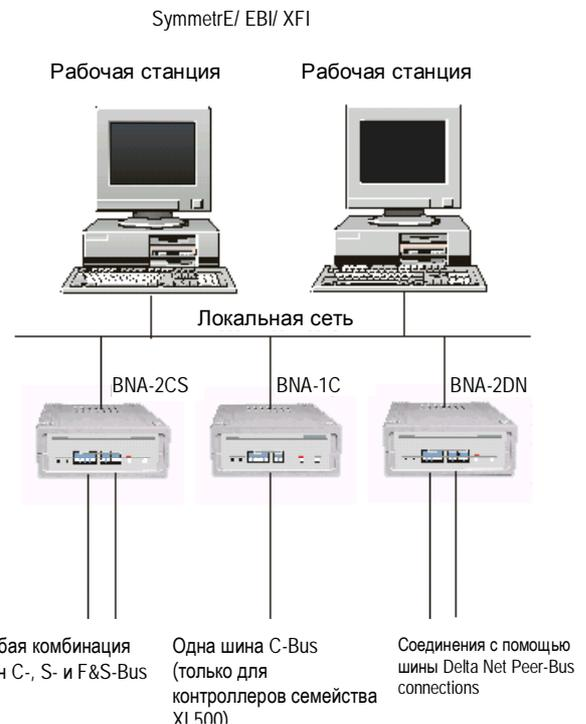
Рис. 1. Пример применения, структурная схема
