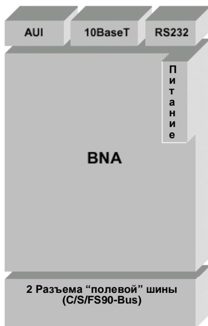
Рис. 2. Компоненты BNA-2CS
