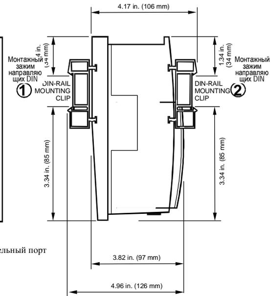
Положение зажима направляющей DIN при установке без MMI (подвод к лицевой панели)
